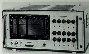
Bild 3. Digitales Umschaltgerät für Normal-Video- und MTI-Video-Darstellung
