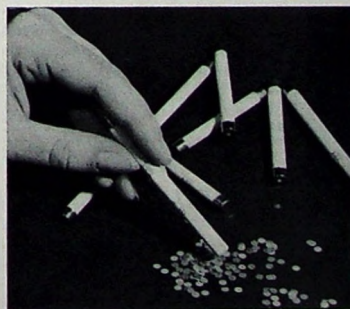
Bild 3. Selen-TV-Hochspannungsgleichrichterstäbe von SEL
